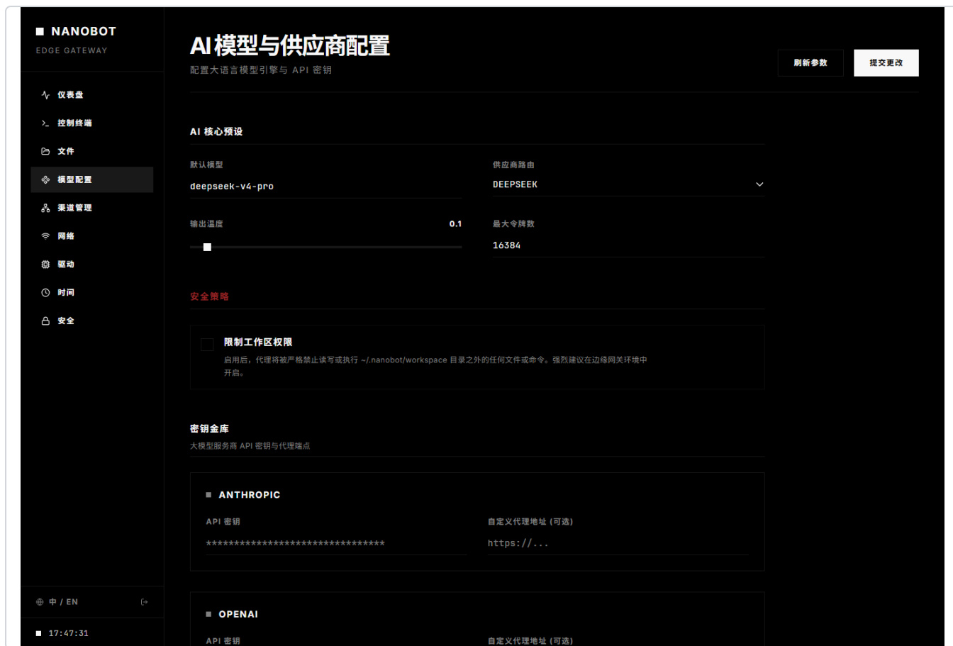
图 4：模型配置页。输入模型名、填入 API 密钥，并建议开启工作区权限限制。
