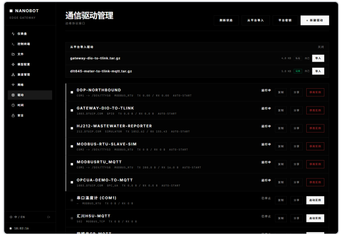
图 10：在网关页面输入密钥后，一键导入云端驱动。
